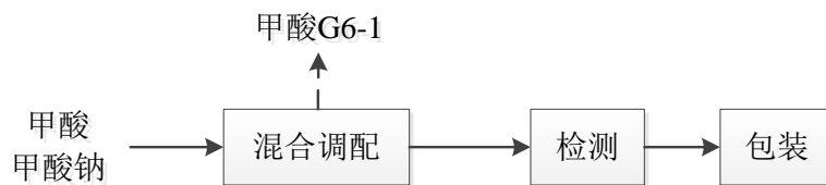
图 2-8 液体有机酸味剂生产工艺流程图示意图
